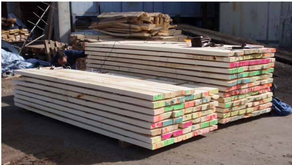
Figura 1. Tablas de madera aserrada con los códigos de colores en las testas
