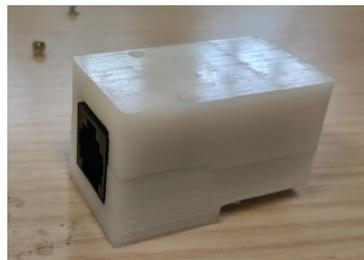
Figura 2. Acelerómetro MEMS encapsulado.
