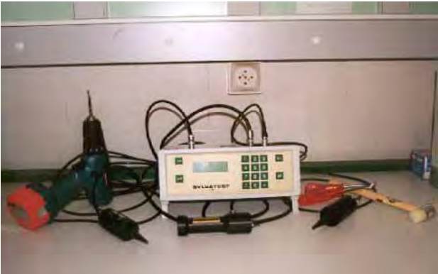
Figura 4. Equipo de ultrasonidos Sylvatest. Sylvatest ultrasound appliance.
