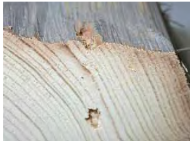
Figura 15. Tornillo en zona sana (lectura de 2,62 kN).
