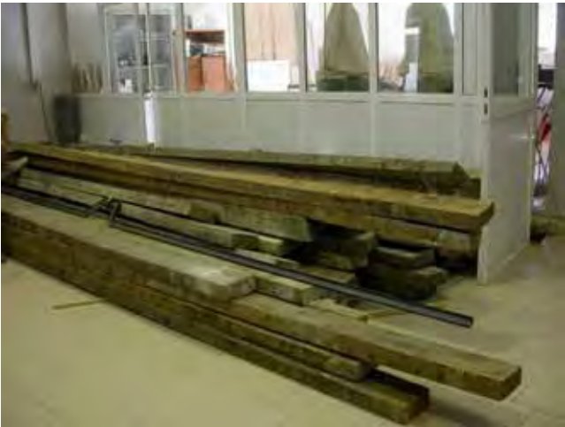
Figura 1b Vigas ensayadas. Tested beams.
