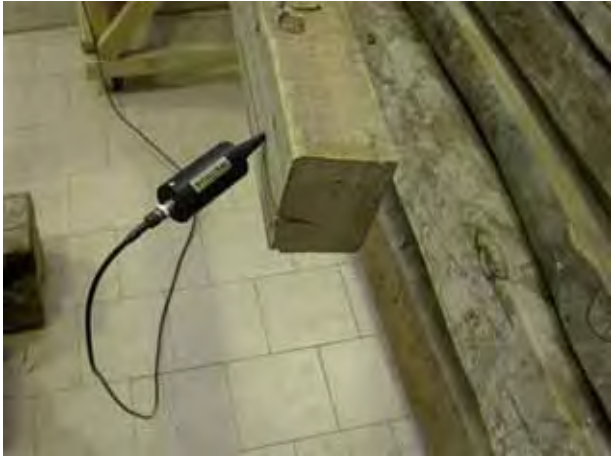
Figura 5. Método indirecto (palpador en la cara con inclinación de 45°). Indirect Method (touching device in the face with 45° tilt)
