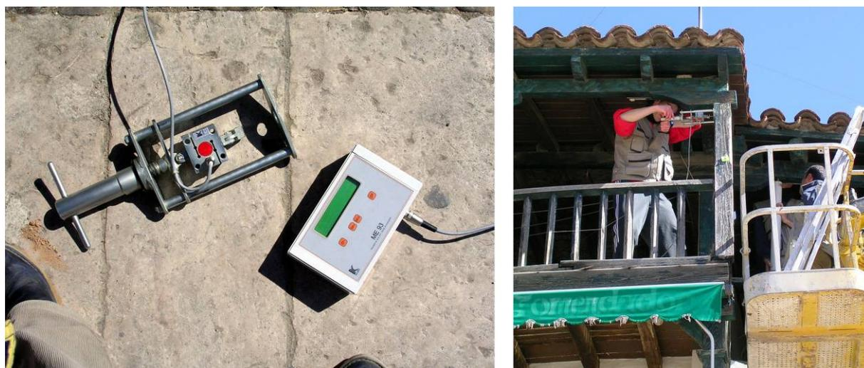
Figura 6 - Extractor de tornillos y su empleo in situ.
