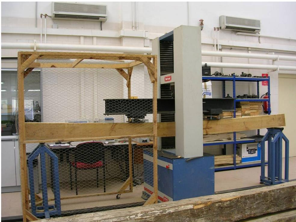
Figura 4 - Ensayo destructivo a flexión para la determinación del módulo de elasticidad global de canto a flexión (MOEGTO).
