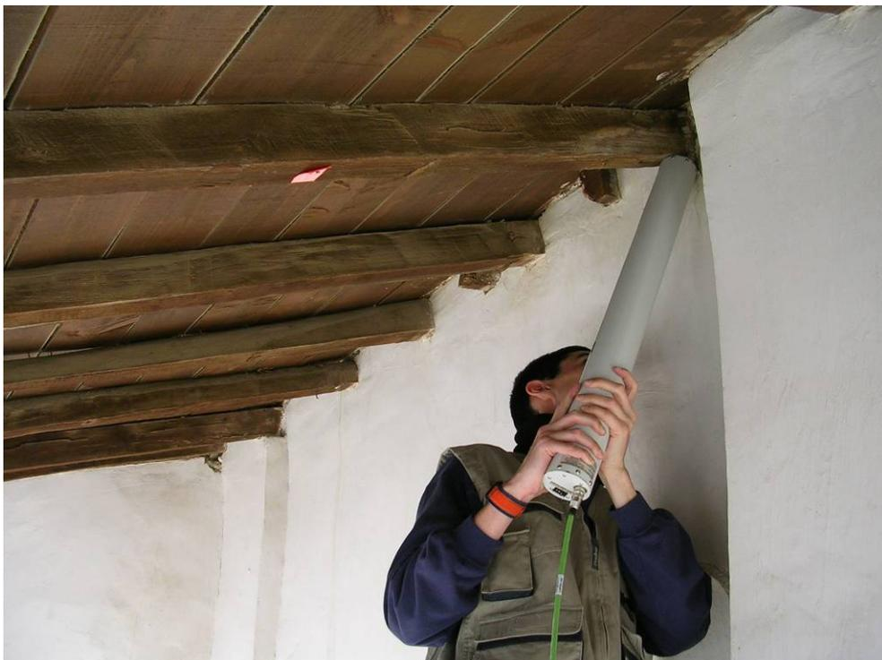
Figura 5 - Utilización in situ del resistógrafo.
