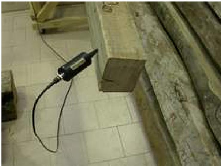
*Imagen 4. Método indirecto, con el palpador emisor colocado en la cara con una inclinación de  $45^\circ$ .*
